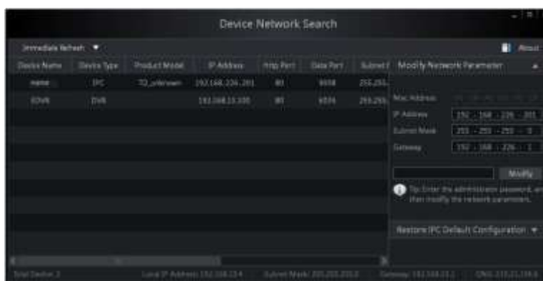
Рис. 2.1. Поиск IP-камеры с помощью утилиты IP-Tool
