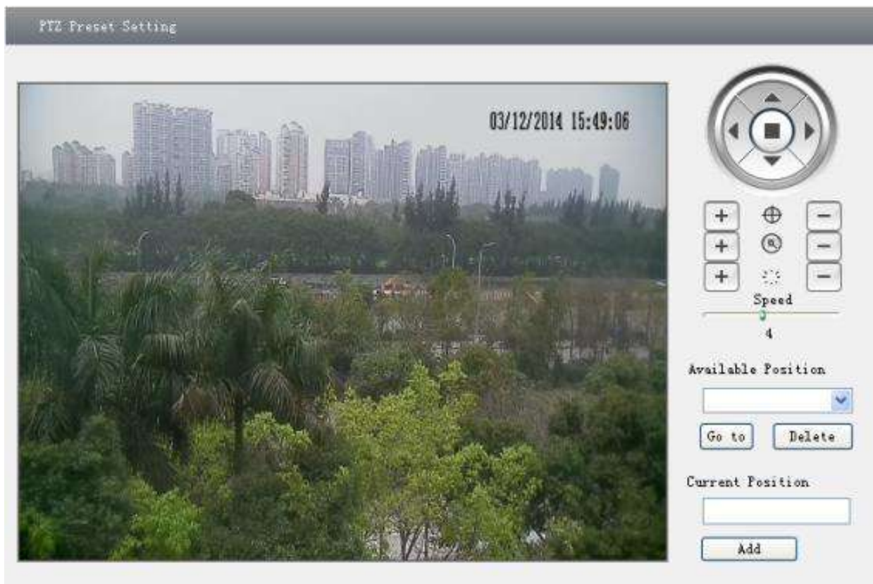
Рис. 4.13. Меню работы с PTZ-предустановками
